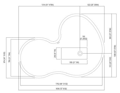
Per un corretto posizionamento del pozzetto e della rubinetteria è necessario utilizzare la dima in cartone con sagoma uguale al profilo superiore della vasca.
